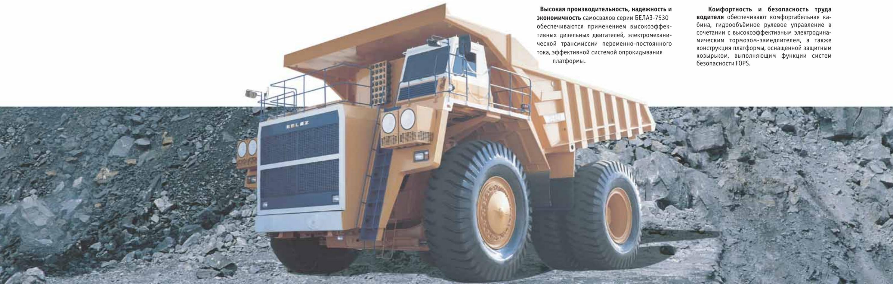
**Высокая производительность, надежность и экономичность** самосвалов серии БЕЛАЗ-7530 обеспечиваются применением высокоэффективных дизельных двигателей, электромеханической трансмиссии переменного тока, эффективной системой опрокидывания платформы.
