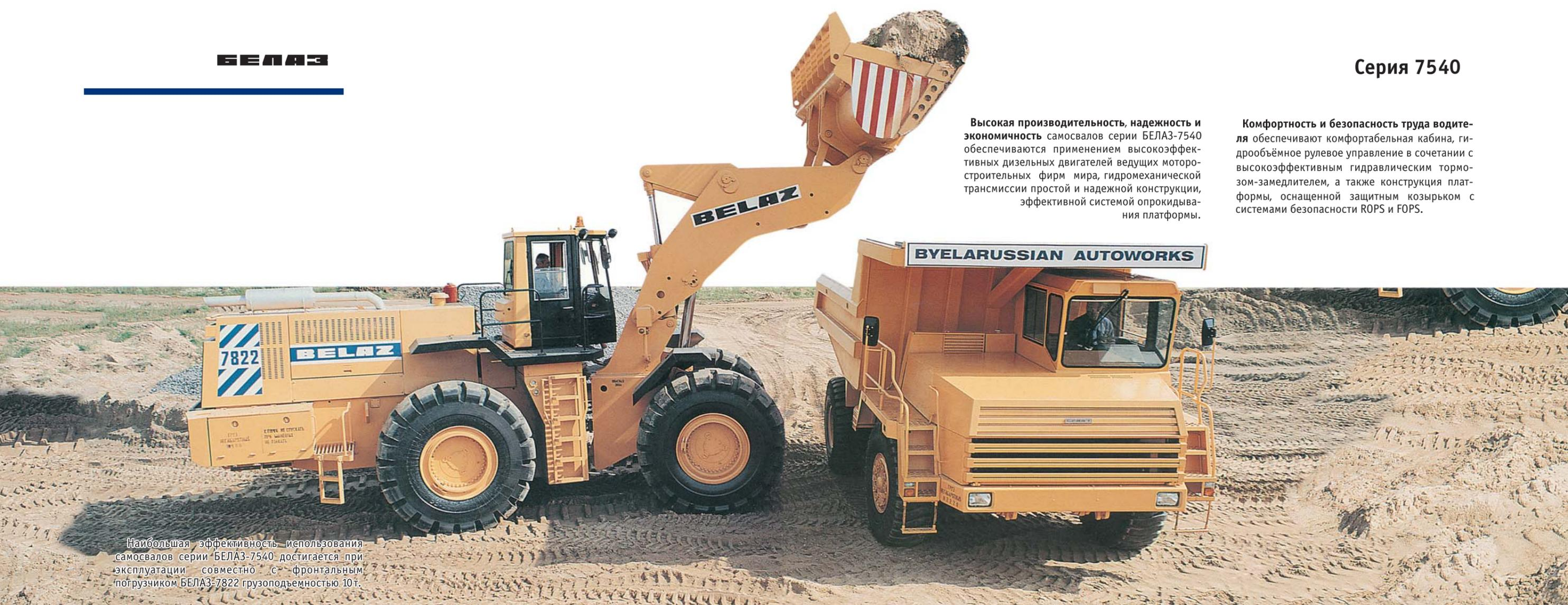
**Высокая производительность, надежность и экономичность** самосвалов серии БЕЛАЗ-7540 обеспечиваются применением высокоэффективных дизельных двигателей ведущих моторостроительных фирм мира, гидромеханической трансмиссии простой и надежной конструкции, эффективной системой опрокидывания платформы.
