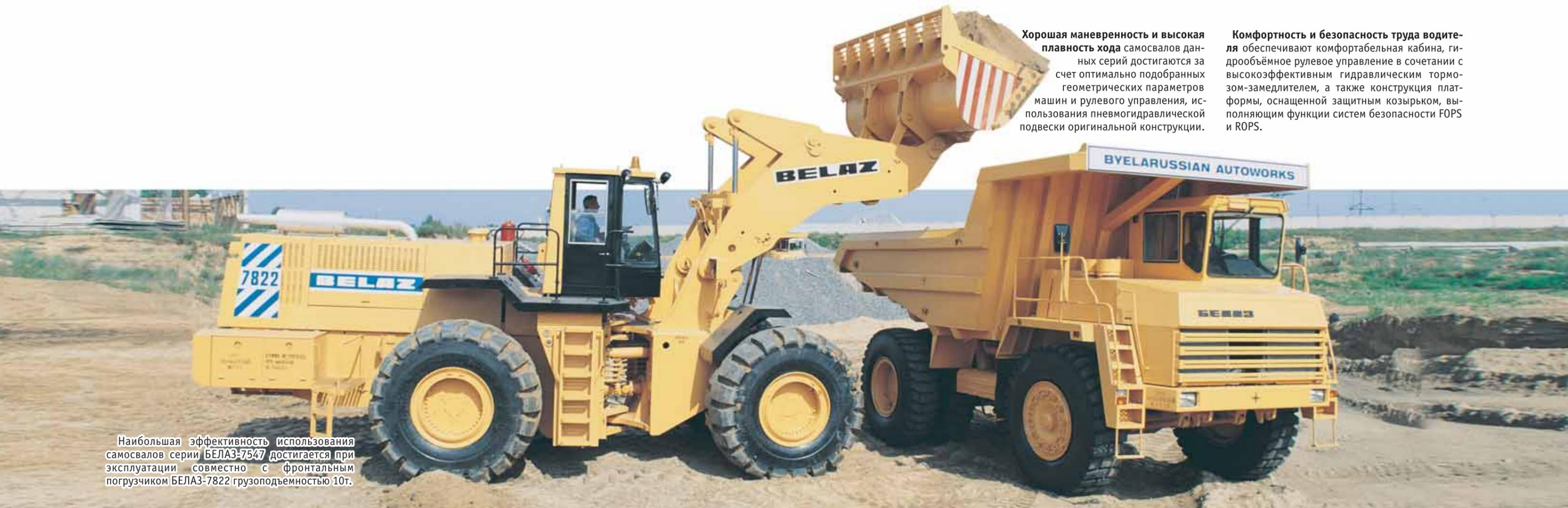
**Хорошая маневренность и высокая плавность хода** самосвалов данных серий достигаются за счет оптимально подобранных геометрических параметров машин и рулевого управления, использования пневмогидравлической подвески оригинальной конструкции.
