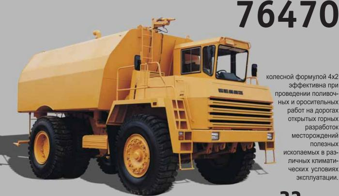
эффективна при проведении поливочных и оросительных работ на дорогах открытых горных разработок месторождений полезных ископаемых в различных климатических условиях эксплуатации.
