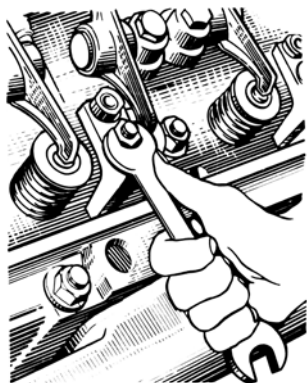
Рис. 89.Отвертывание гайки скобы крепления форсунки
