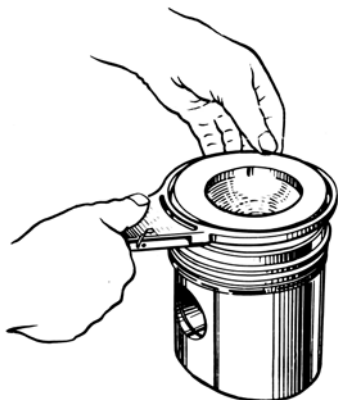
Рис. 95. Снятие и надевание поршневых колец на поршень
