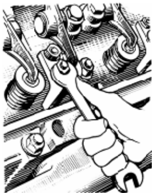
Рис. 81. Отвертывание гайки скобы крепления форсунки
