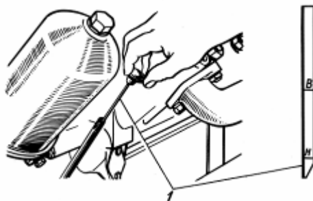
Рис. 60. Проверка уровня масла в поддоне двигателя: 1—указатель уровня масла.
