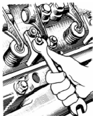
Рис. 74.Отвертывание гайки скобы крепления форсунки
