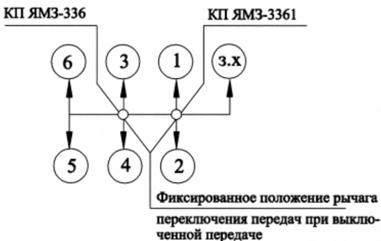
Рис. 111. Схема переключения передач КП.
