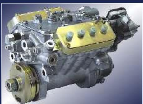
ТНВД V-образного семейства - это топливные насосы высокого давления с V-образным расположением плунжерных пар, количеством секций: 6, 8, и межсекционным расстоянием 36 мм. Устанавливаются на V-образные дизельные и газодизельные двигатели объемом цилиндра до 2 литров и мощностью до 35 кВт на цилиндр.
